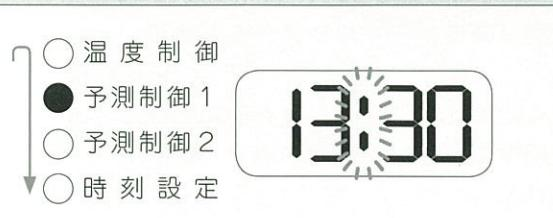
床内に設けられた温度センサーによって、床内の温度が設定された温度になるように、通電中ON・OFF制御を行います。
