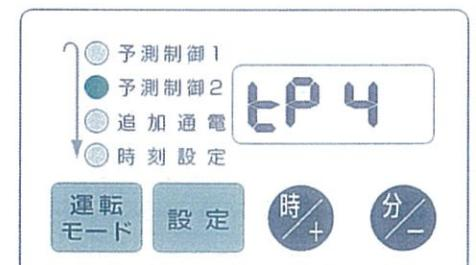
以上の全パラメータ設定後、「**設定**」スイッチを押すか、1分以上放置すると、変更したパラメータの値が入力され、運転モードに戻ります。
