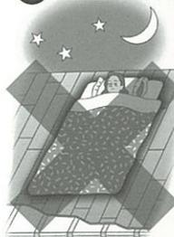
通電中に床暖房敷設場所で床にじかに寝ないでください。放熱を妨げ熱がこもり、ヒーターの過熱や低温やけどの恐れがあります。また、温度センサーの上に寝る場合も③の場合と同じように温度調節が不調となり、床暖房が順調に行われません。
