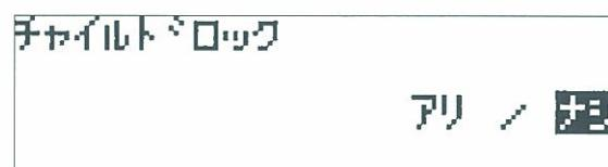
**4** 解除は、①②の手順で設定画面にし、**または**キーにより「ナシ」を選択し、**設定**スイッチを押してください。初期画面に戻りカギ型のシンボルマークが消えます。
