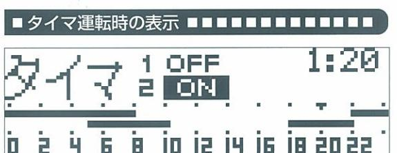
運転中の画面には、ゾーン1、ゾーン2の現在の通電状況を、「ON」「OFF」で表示されます。右上には、現在時刻が表示されます。画面下部には、ゾーン毎にタイマ設定された通電時間帯が、バー表示され、**T**マークにより現在時刻が表示されます。
