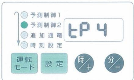
以上の全パラメータ設定後、「設定」スイッチを押すか、1分以上放置すると、変更したパラメータの値が入力され、運転モードに戻ります。
