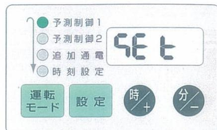
**2** **設定** スイッチを3秒間押します。「SEt」と表示してパラメータ設定モードに切替わります。
