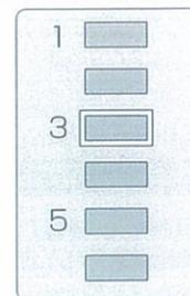
故障表示が出た場合には、そのままの状態にして、できるだけ速やかに、保証書記載の販売店まで、ご連絡ください。異常点検・修理後にエラー表示ランプの点滅を消す時は操作電源を一旦OFFにして、再度操作電源をONにしてください。
