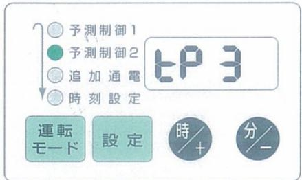
**6** 引き続き **予測制御2** のヒーター2回路の運転パラメータを設定する
